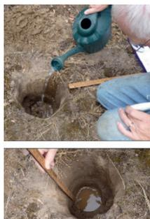
Test di infiltrazione
