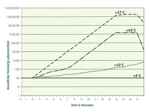
Die Tabelle veranschaulicht das unterschiedliche Wachstumsverhalten eines mesophilen Keims bei unterschiedlichen Lagertemperaturen. Bei einer Temperatur von +4°C ruht das Wachstum, während bei +37°C die Wachstumskurve steil ansteigt und innerhalb weniger Stunden hohe Keimbelastungen erreicht. Eine konsequente Kühlung ist somit die wichtigste Voraussetzung, um das Wachstum schädlicher Mikroorganismen zu verhindern.
